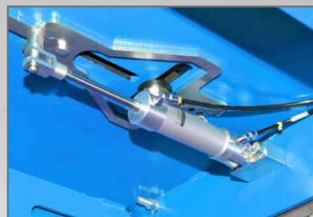
**7. Lift-table con doble cilindro de elevación y dobles extensiones** delanteras y traseras para mayor flexibilidad en la toma de los puntos de elevación, no es necesario ningún movimiento del vehículo en el elevador.
