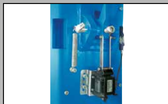
Entriegelung der Sicherungen mit Elektromagnet 24V.
