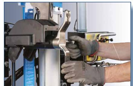
**OPERACIÓN DE DESMONTAJE DEL TALÓN INFERIOR CON LA AYUDA DEL DISCO DESTALONADOR INFERIOR.**
