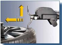
DIE MANUELLE WERKZEUGDREHUNG ERMÖGLICHT EINEN EXTREM EINFACHEN UND SCHNELLEN WECHSEL VON DER DEMONTAGE ZUR MONTAGE.
