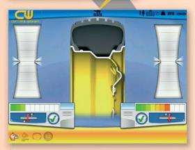
Due veicoli possono avere ruote simili per dimensioni e peso e quindi anche per momento di inerzia, ma in base all'effetto dello squilibrio, proportzionale al quadrato della velocità, necessitano di una diversa e specifica equilibratura. Questi valori, fondamentali per un'equilibratura ottimale, grazie a **Minimal Weight** vengono selezionati dall'operatore e automaticamente il programma calcola tutti gli altri parametri.
