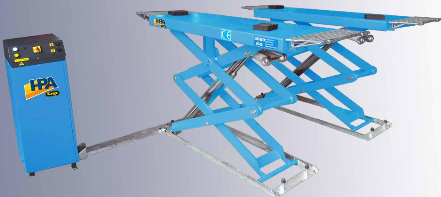
Sollevatore elettroidraulico sottoscocca a doppia forbice, per gommisti, autoriparatori e carrozzieri. Allineamento pedane con doppia coppia di cilindri e sistema **MASTER/SLAVE** senza cremagliere. Pedane in versione con flaps (**F**). Tutti i modelli disponibili nelle versioni a pavimento e ad incasso.
